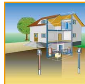
Pompe à chaleur
